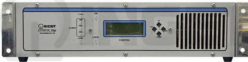
**EL IGTE-50WD** Es excitador de 50W vatios FM de 88 a 108 Mhz de Banda ancha construido con tecnología de estado sólido, En su panel frontal por medio de un LCD se Visualizan los estados Tales como Frecuencia de operación Potencia emitida y reflejada, El Voltaje de operación es 120 ó 230 voltios AC según pedido.
